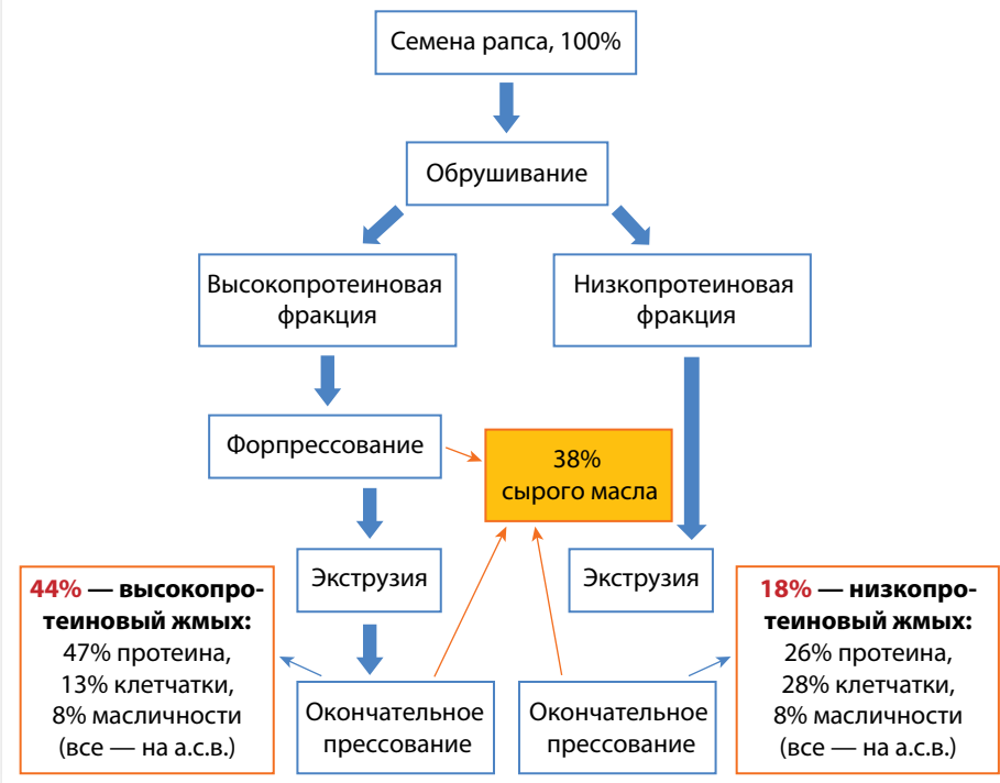
Рис. Схема технологии переработки семян рапса с частичным обрушиванием семенной оболочки и разделением на две фракции
